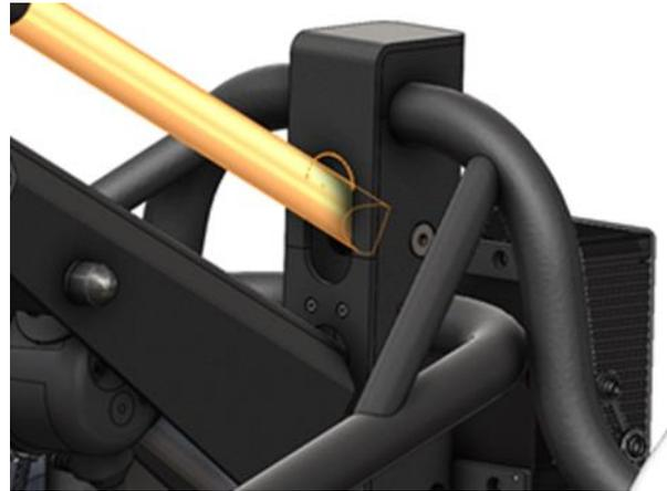
**Figura 8 Asegúrese de que dispone de espacio suficiente en la zona por la que se va a desplazar para minimizar el riesgo de atrapamiento.**
