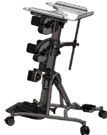
SOPORTE DE MESA CON LA PARTE CÓNCAVA HACIA LA PARTE TRASERA DEL DISPOSITIVO
