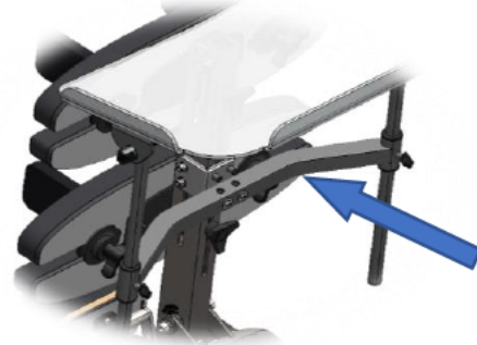
SOPORTE DE MESA CON LA PARTE CÓNCAVA HACIA LA PARTE TRASERA DEL DISPOSITIVO
