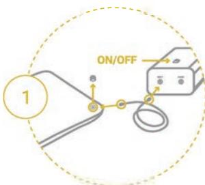
Desenrosque el tapón de la válvula, enrosque la manguera en la válvula del cojín, presione la otra parte en el enchufe SOFT y encienda la bomba. Espere hasta que el cojín esté lo suficientemente blando, entonces apaga la bomba.
