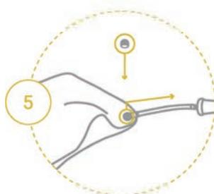
Desenrosque la manguera del cojín y enrosque el tapón de seguridad en la válvula.
