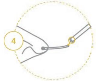
Conecte la bomba de aire a la manguera y aspire el aire hasta que se alcance la dureza deseada.
